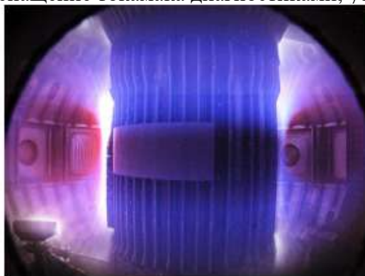
Рисунок 1. Плазменный разряд в Т-15МД: а) плазма в Т-15МД; б) осциллограммы токов плазмы в нескольких импульсах (номера указаны в поле рисунка); в) температура плазмы в центре вакуумной камеры, измеренная диагностикой томсоновского рассеяния
