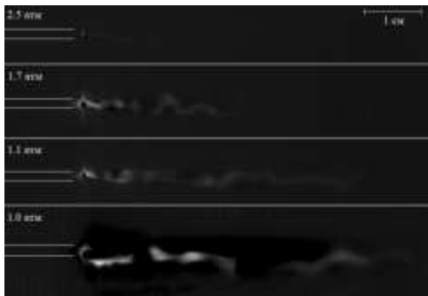
Рис. 1. Сборка кадров видеосъемки СВЧ разряда при различных давлениях в потоке. Экспозиция кадров 2 мкс. Скорость воздушного потока 200 м/с, направлен слева направо. Вектор напряженности поля E параллелен потоку.
